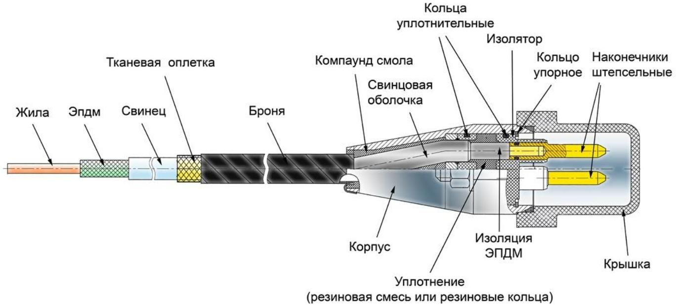
Дополнительную фиксацию кабеля в муфте обеспечивает теплостойкий масло- и водостойчивый компаунд, который заливается в хвостовик муфты.
